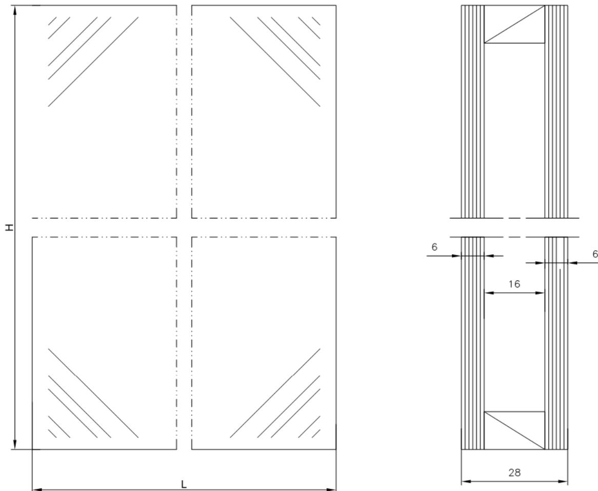
Zestawienie wymiarów szyb do badań modelu ściany osłonowej MB-SR50N EI30 od strony wewnętrznej.
